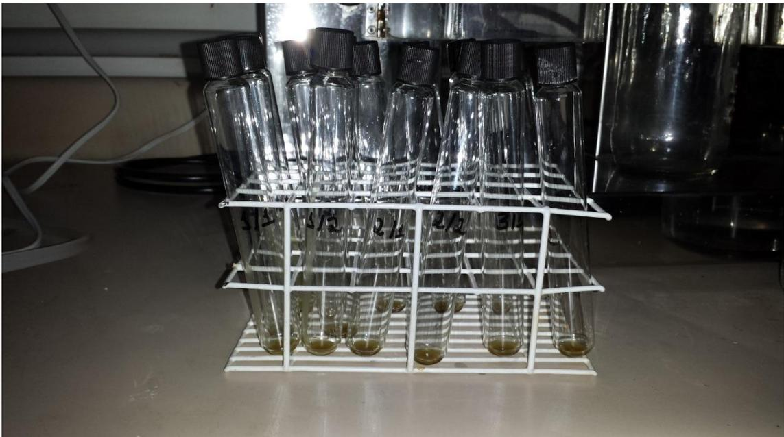
Figura 5. Tubos de ensaio contendo extrato para análise de peróxidos.
