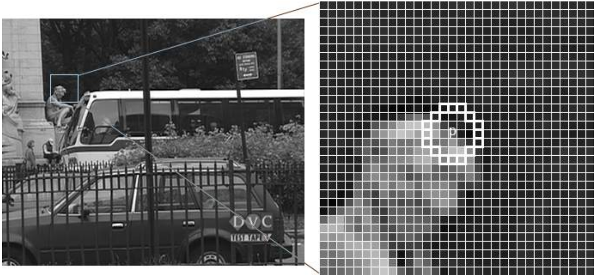
Figura 33 – Círculo de Bresenham utilizado no algoritmo FAST. Adaptado de (ROSTEN; DRUMMOND, 2006).
