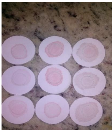
Figura 10 – amostra de tinta diluída com xileno aplicada em papel filtro após evaporação do solvente
