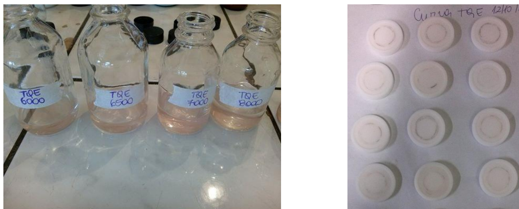
Figura 12 – Diluições sucessivas de uma amostra de tinta (à esquerda) e aplicação nos discos de teflon para análise por LIBS e construção de uma curva analítica
