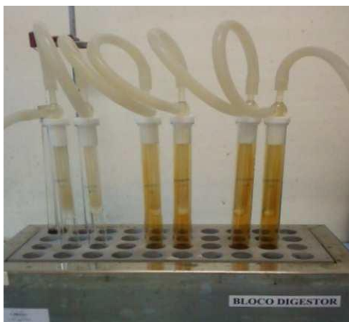
Figura 4 – Foto durante um processo de decomposição das amostras de tintas anti-incrustantes no bloco digestor com os tubos equipados com sistema de refluxo.
