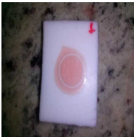
Figura 11 – amostra de tinta diluída com xileno aplicada em teflon após evaporação do solvente
