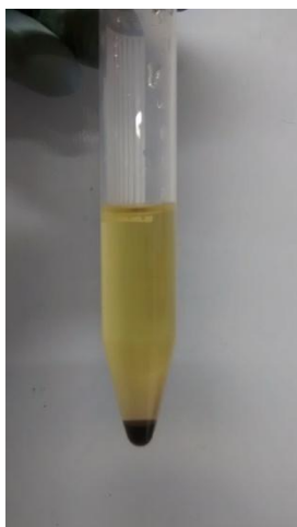
Figura 10. Amostra de carvão no processo final da decomposição ácida parcial.
