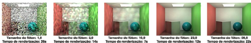
Figura 2: Visualização dos resultados do experimento 1, que se refere à alteração do tamanho dos fótons, registrando-se o tempo de renderização respectivo.
