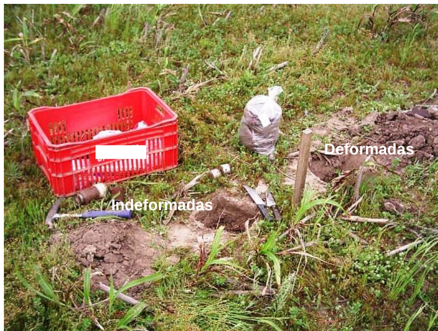
Figura 4 – Detalhe do posicionamento de coleta das amostras deformadas e indeformadas em relação ao ponto referenciado.
