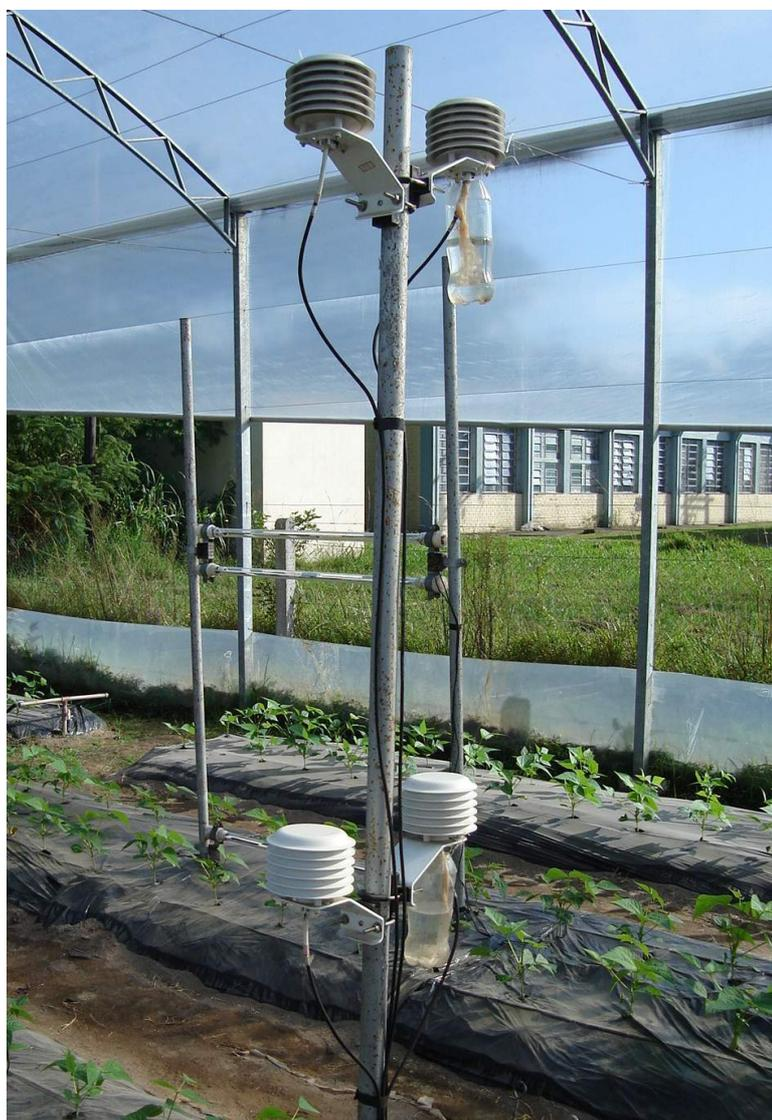
Figura 2C – Termômetros
