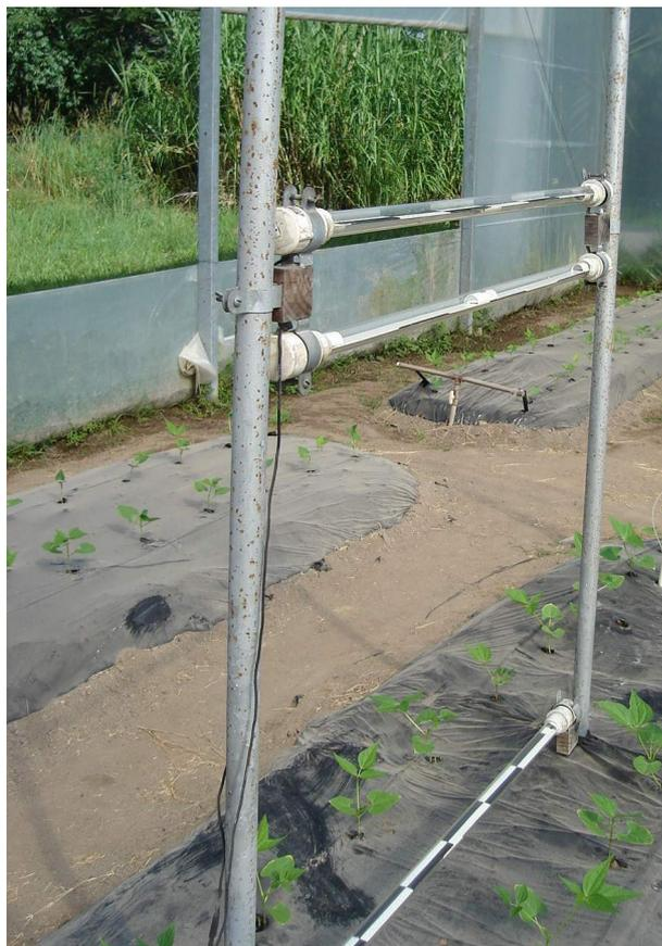
Figura 3C – Tubos solarímetros
