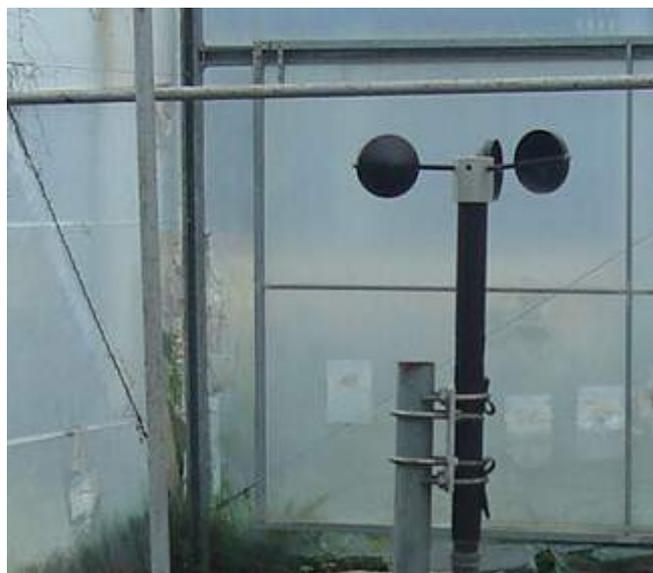
Figura 4C – Anemômetro
