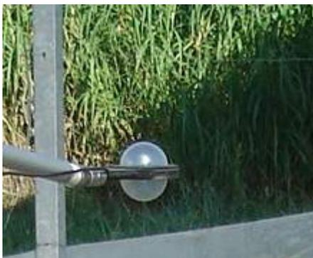
Figura 1C – Saldo radiômetro
