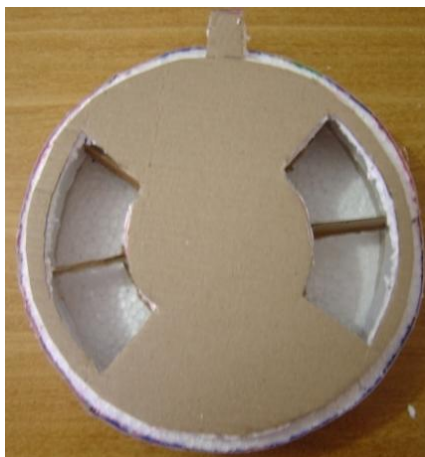
Figura 35: Montagem do sistema de dosagem de fertilizante
