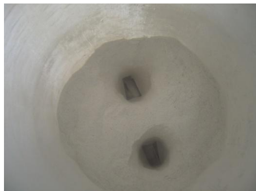
Figura 54: Comportamento do calcário dentro do sistema de armazenagem
