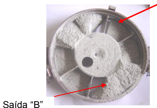
Figura 47: Aspecto do pó de rocha no interior do dosador após a retirada do reservatório
