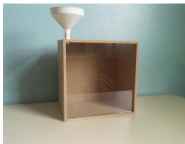
Figura 13. Caixa e funil utilizados na determinação do ângulo de repouso
