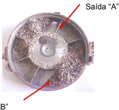
Figura 44: Aspecto do fertilizante NPK 05-20-10 no interior do dosador após a retirada do reservatório
