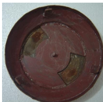
Figura 36: Vista superior da conexão cônica do dosador ao reservatório
