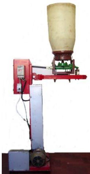
Figura 15. Vista geral da bancada de ensaio com o dosador montado.
