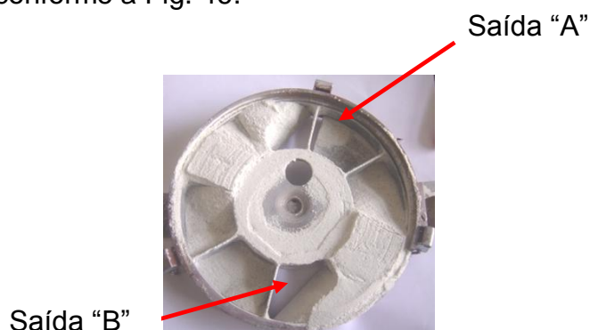
Figura 46: Aspecto do calcário no interior do dosador após a retirada do reservatório
