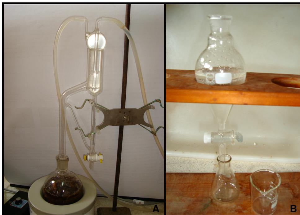
**Figura 2**– Aparelho Clevenger acoplado a um balão de fundo redondo de 1 L utilizado para extração de óleo essencial por hidrodestilação (A) e funil de separação de 100 mL utilizado para purificar o óleo essencial através e lavagens com solvente (B).
