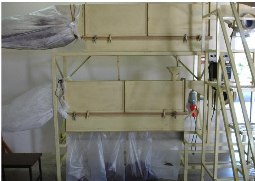
Figura 11. Ventilador de sementes de tabaco onde foram submetidas a dois tubos de ventilação que separam partículas de poeira, sementes e partículas mais pesadas.
