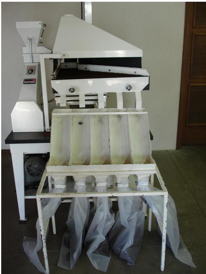
Figura 12. Mesa de gravidade de sementes de tabaco onde foram separadas em classes e lotes diferentes conforme padrão da Unidade de Beneficiamento da Universal Leaf Tabacos, considerado a densidade das sementes
