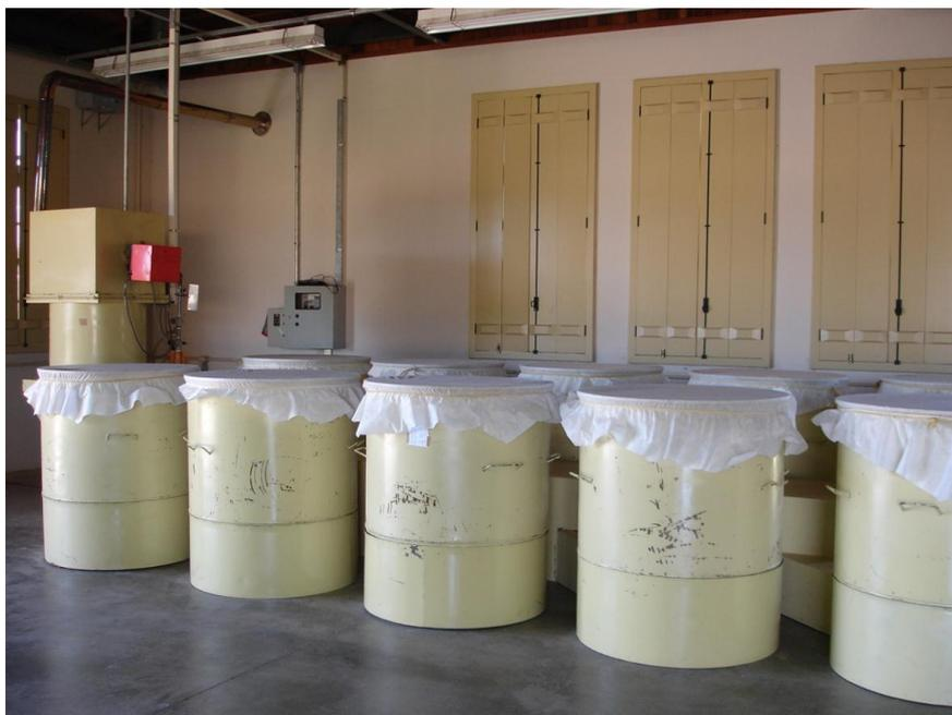
Figura 10. Secador de sementes de tabaco onde foram acondicionadas nos recipientes de secagem por aproximadamente 72 horas com monitoramento de temperatura e de umidade.
