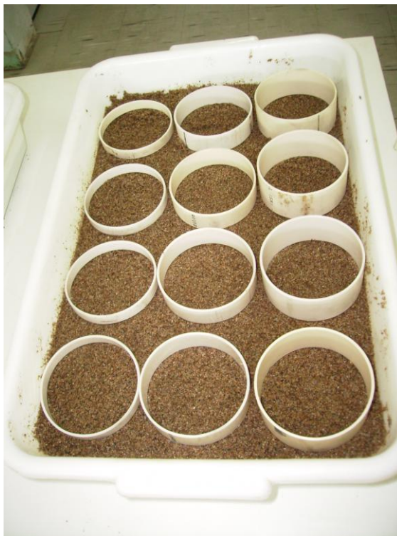
Figura 2. Bandeja, areia e discos limitadores de profundidade (não preenchidos com areia) utilizados para realização do teste de emergência de plântulas e índice de velocidade de emergência de quatro lotes de sementes de azevém anual ( Lolium multiflorum Lam.).
