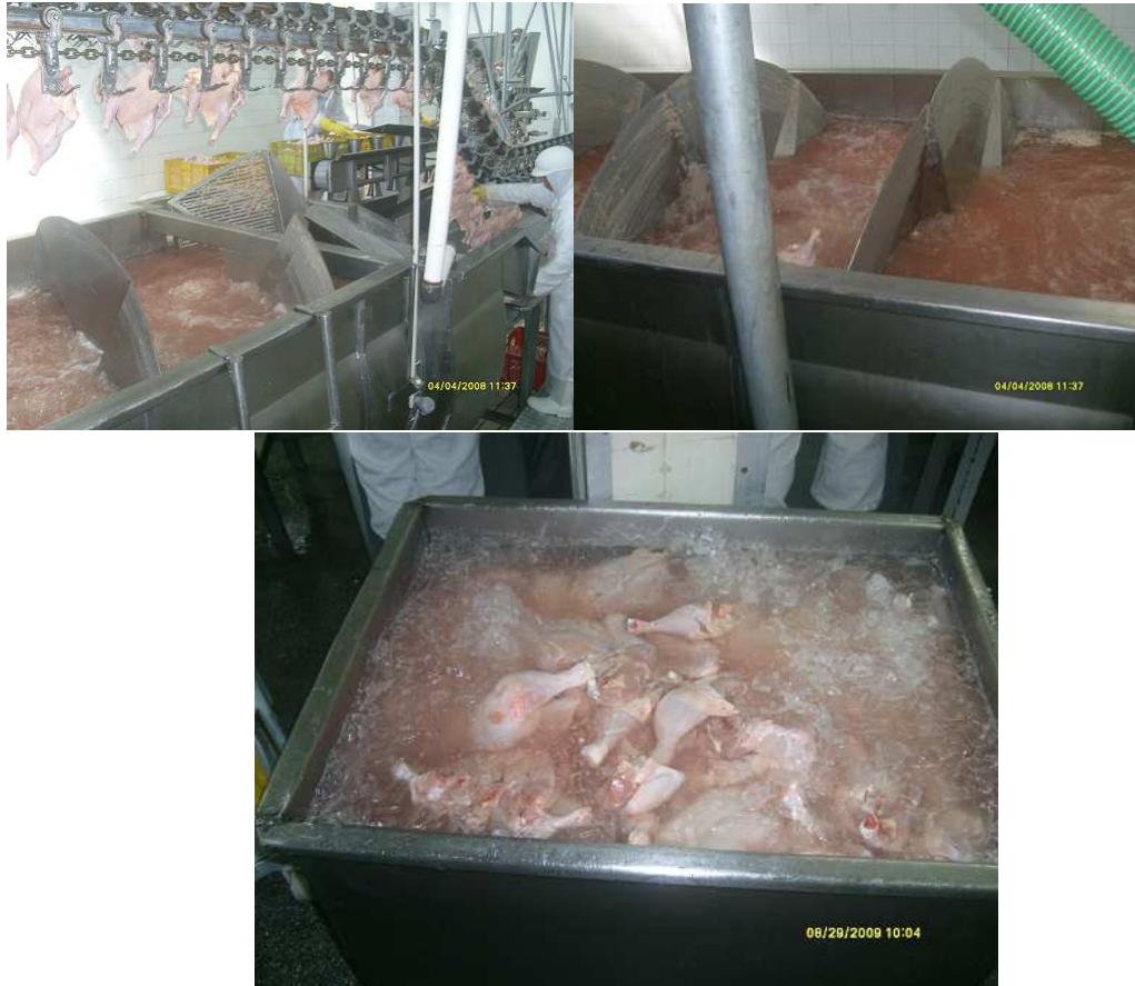
Figura 9 - Processo de pré-resfriamento em chillers .
