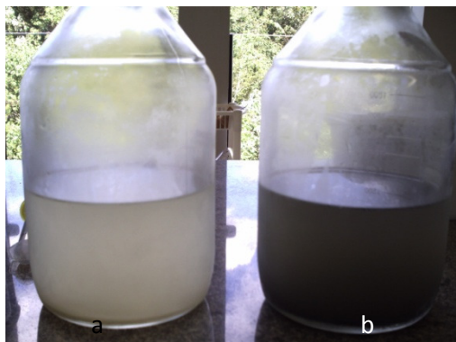
Figura 9 – Reatores com inóculo acidogênico (a) e inóculo anaeróbico tratado termicamente(b) no tempo zero de experimento.
