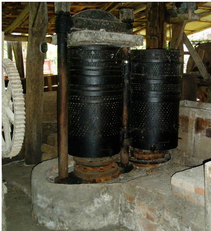
Figura 84: Prensa de dois cilindros. Atafona Henkel. Nova Hartz. RS
