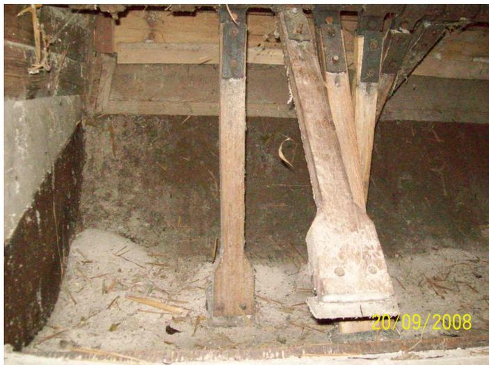
Figura 86: Detalhe do tacho com as pás giratórias que removem a farinha. Atafona Henkel. Nova Hartz. RS
