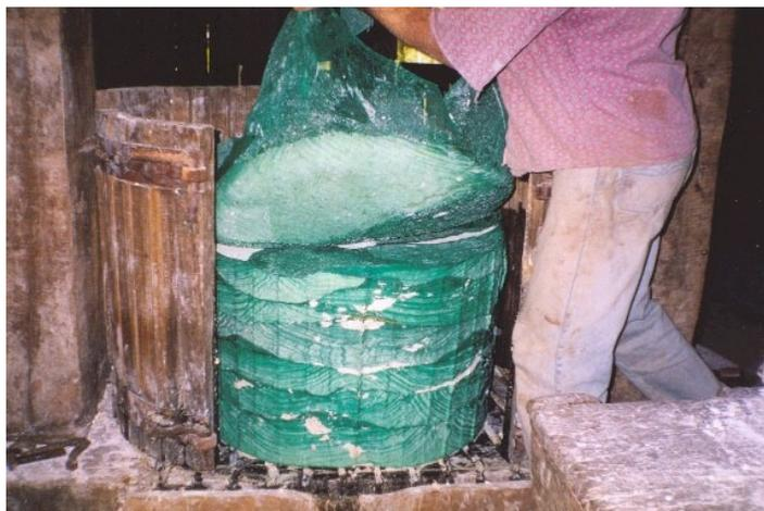
Figura 96: A massa prensada disposta em camadas separadas por tela plástica.
