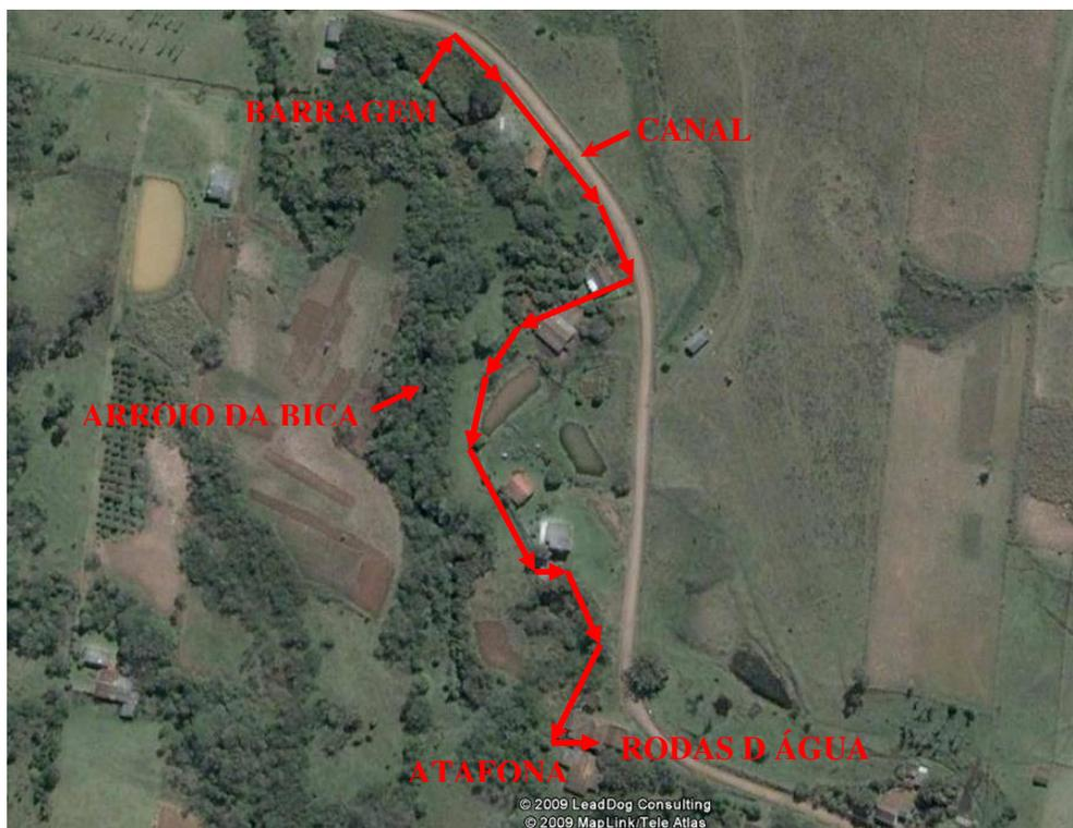
Figura 70: Traçado do canal condutor da água, da barragem até as rodas. Atafona e Moinho Henkel. Nova Hartz. RS
