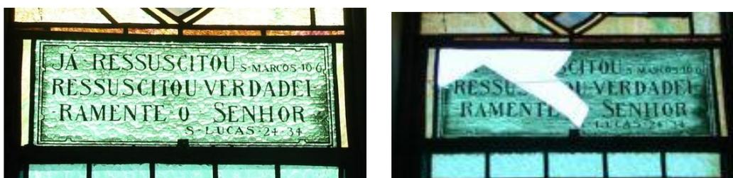
Figura 97: Vista externa da base do painel JO1 antes e depois do lançamento do projétil.
