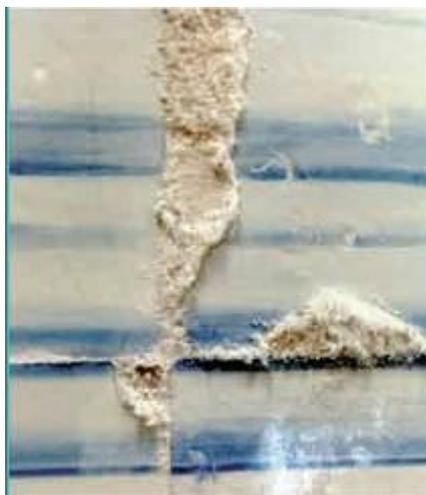
Figura 24 – Dano ocasionado por degradação por eflorescência em um fragmento de faiança.
